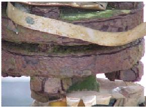
A flange a esquerda está severamente corroída e os parafusos estão em mal estado. Um vazamento prestes a ocorrer. Felizmente, esta condição foi observada durante uma inspeção e o flange foi substituído (mostrado a direita)
